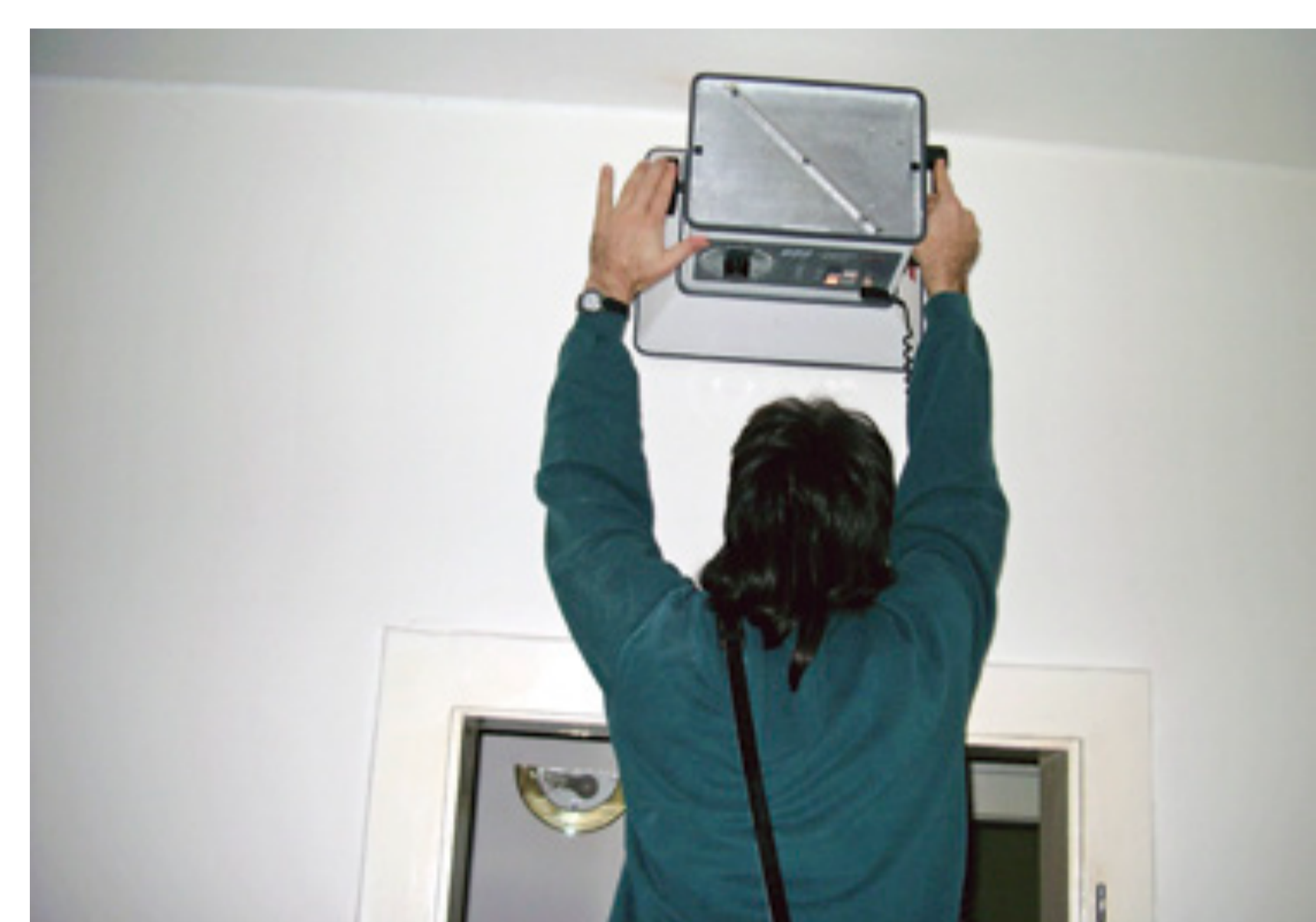
Вимірювання об'ємного потоку дифузора подачі повітря під час регулювання системи
