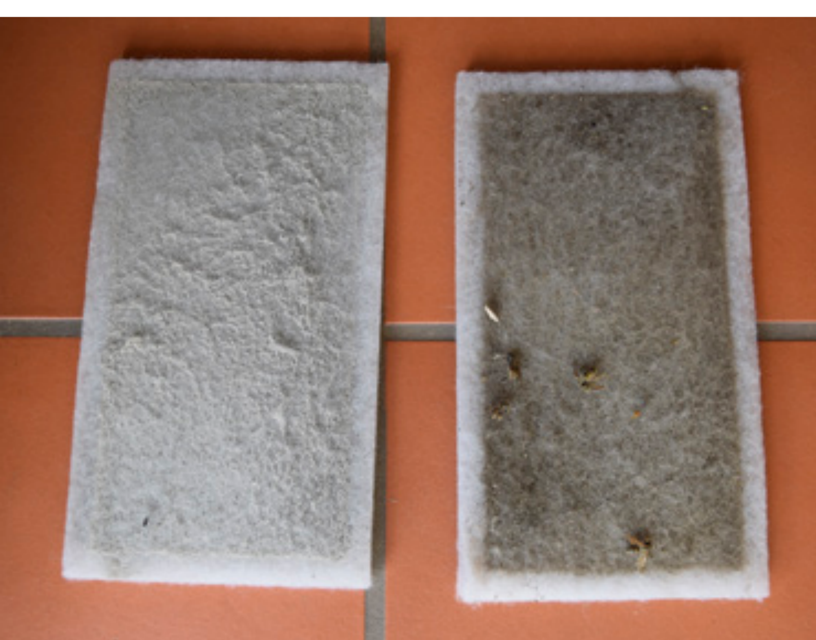
Стан фільтрів відпрацьованого повітря і подачі повітря після шести місяців експлуатації (вище); зручна зміна фільтра: витягніть старий фільтр і вставте новий фільтр (справа)
